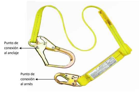
Elemento parte de un sistema personal para detención de caídas de una terminal fija. Posee un punto de conexión que va al arnés y un punto de conexión que va al anclaje. Recomendada para ser usada en conjunto con los arneses de seguridad usando únicamente como punto de conexión la argolla dorsal para restricción de caídas.
