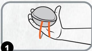
Sostenga el Respirador INSAFE de manera que la parte externa esté apoyada en la palma y los elásticos permanezcan por debajo de la mano.
